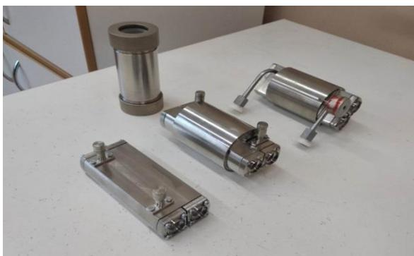
Рис. 3. Оптические кюветы для спиртомеров типа «ИКОНЭТ»
