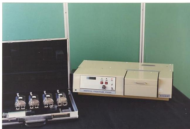
Рис. 4. Оптический спиртомер «ИКОНЭТ-ВС»
