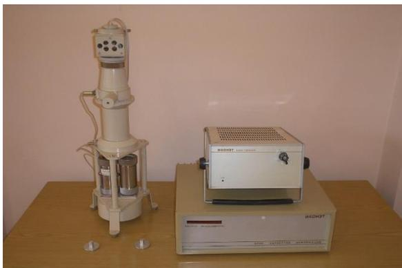
Рис. 2. Оптический спиртомер «ИКОНЭТ-Мастер прибор»
