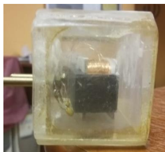
Рис. 6. Катушка индуктивности в пластиковом корпусе и с вилкой
