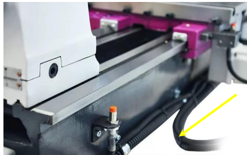
Рис. 1. Пример установки индуктивного датчика перемещения на станке с управляющей платформой Fanuc
