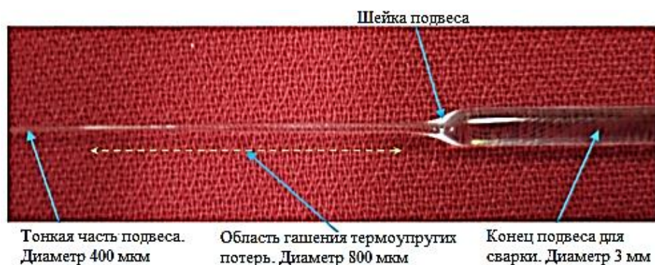
Рис. 2. Усовершенствованный конец волокна LIGO с указанием секций
