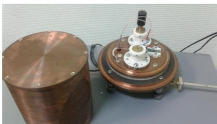
Рис. 2. Внешний вид микрокалориметра с подключённым болометрическим преобразователем
