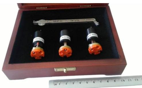
Рис. 4. Внешний вид комплекта ПБП для волноводного тракта WR10
