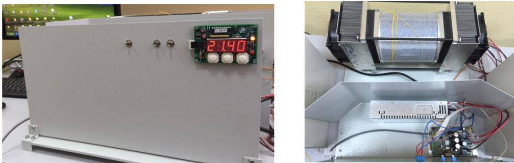
Рис. 4. Внешний вид управляемой оптической линии задержки
