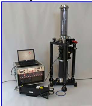
АБГ FG-5X MicroG-Lacoste Погрешность: 2-3 мкГал
