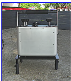
ВОГ Burris Gravity Meter™ (США) Погрешность: 5 мкГал
