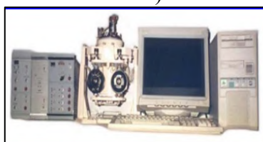
Мобильный комплекс морского гравиметра ГМН-КМ Погрешность: менее 1 мГал
