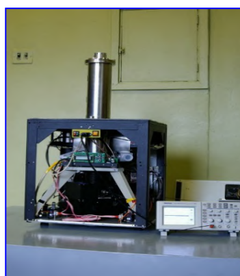
Полевой АБГ ГАБЛ (СО РАН) Погрешность: 20 мкГал
