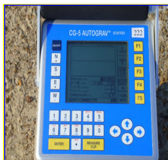
ВОГ Scintrex CG-5 (Канада) Погрешность: 5 мкГал
