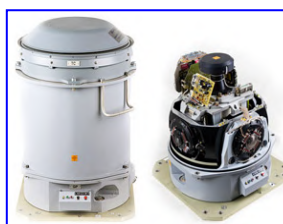
Мобильные гравиметрические комплексы ЧЕ-КАН-АМ, Попугай Погрешность: менее 1 мГал
