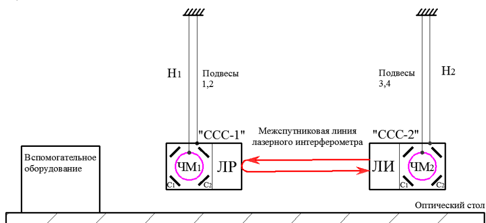
Рис. 2. Схема наземного макета «спутников свободных от сноса» совместно с оптическим интерферометром
