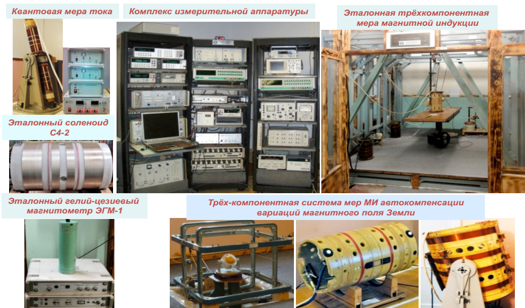
Рис. 2. Фото основных узлов эталонного комплекса для воспроизведения и передачи единицы магнитной индукции постоянного поля в диапазоне 1 \cdot 10^{-8} - 1 \cdot 10^{-3} Тл
