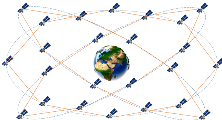
Рис. 1. Топология взаимных измерений в градиентометре по линии «высокий спутник-высокий спутник»
