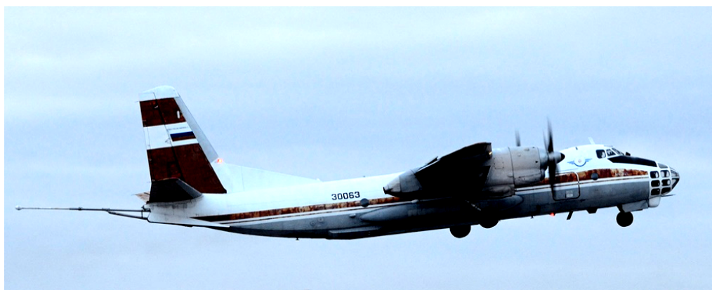
Рис. 3. Летающая лаборатория на базе Ан-30Д, ведущая съемки АМПЗ на различных эшелонах высот. Магнитные датчики вынесены в немагнитный стингер
