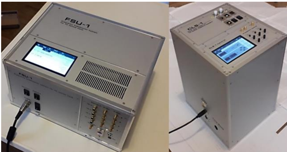
Рис. 3. Блок стабилизации частоты FSU-1 (слева). Размеры — 33 \times 26,5 \times 17,5 см 3 , масса — 15,5 кг, потребляемая мощность — 10 Вт. Часовая лазерная система CLS-1 (справа). Размеры — 32 \times 29 \times 25 см 3 , масса — 17,2 кг, потребляемая мощность — 10 Вт
