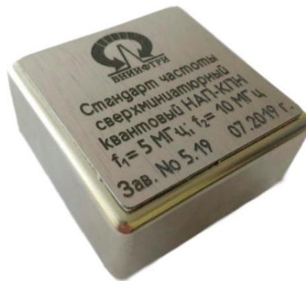
Рис. 1. Миниатюрный квантовый стандарт частоты на основе КПН-эффекта
