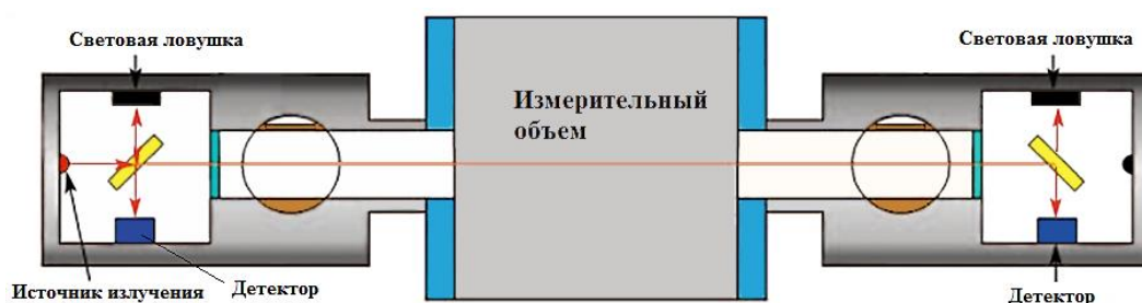
Рис. 2. Оптическая схема измерителей массовой концентрации на основе ослабления лазерного излучения
