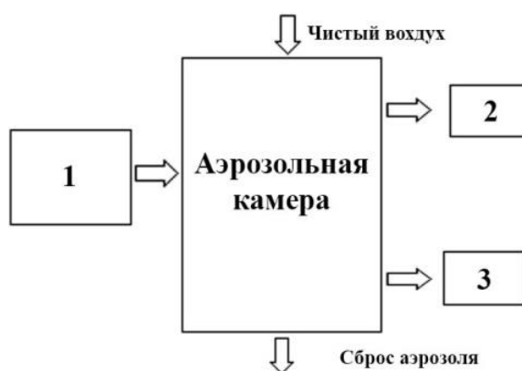
Рис. 6. Схема проведения сличения: 1 — генератор аэрозоля; 2, 3 — аппаратура участников
