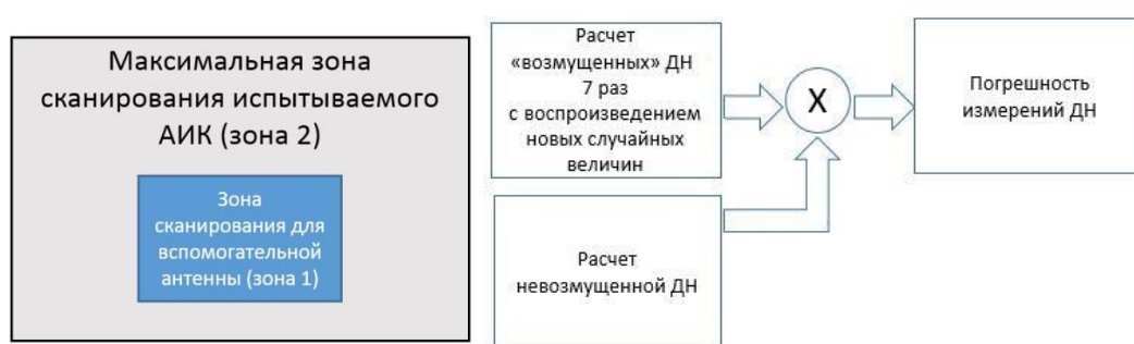
Рис. 3. Диаграмма определения метрологических характеристик АИК БЗ поэлементным подходом
