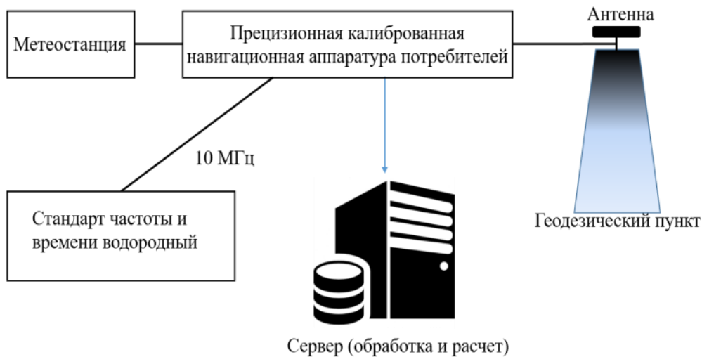
Рис. Схема измерений при оценке эксплуатационных характеристик базовой навигационной услуги системы ГЛОНАСС
