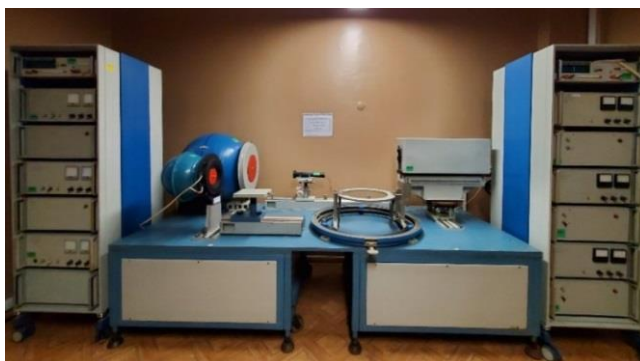
Рис. 4. Государственный рабочий эталон единицы СПЭЯ 1 разряда в диапазоне длин волн 0,36...2,00 мкм
