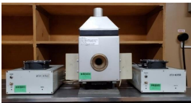
Рис. 5. Государственный рабочий эталон единицы СПЭЯ 1 разряда в диапазоне длин волн 0,22...0,42 мкм
