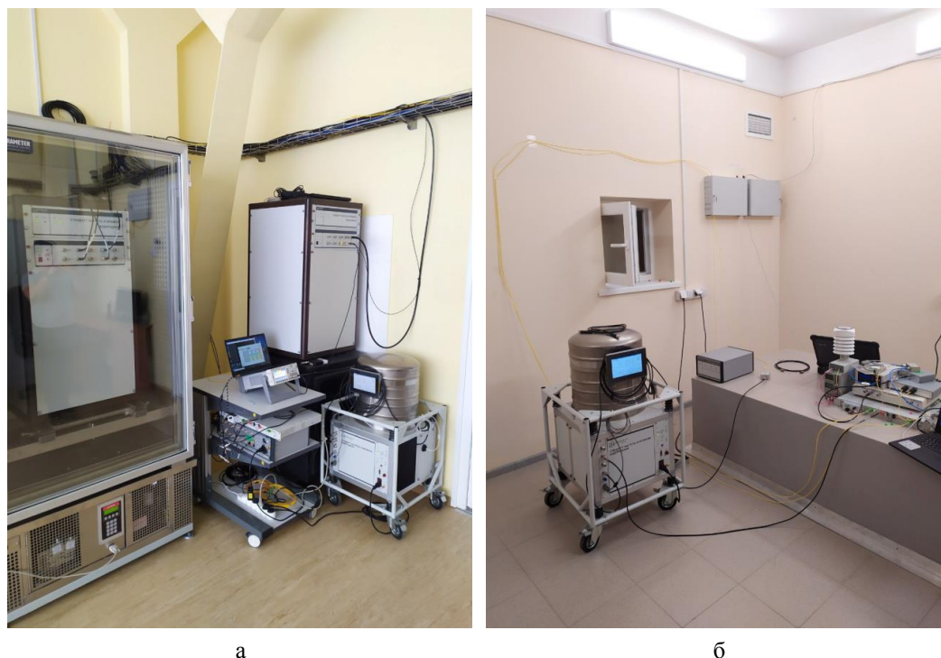
Рис. 1. Размещение экспериментального оборудования: а — на шестом этаже (слева — стационарные термостатированные квантовые часы Ч1-1003М, справа внизу — перевозимые часы ПКЧ-Н); б — ПКЧ-Н на минус первом этаже; в правом верхнем углу показано оптическое коммуникационное оборудование
