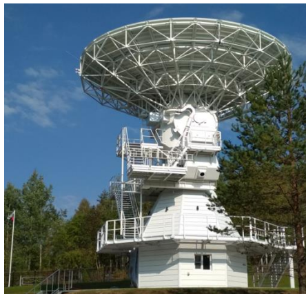
Рис. 6. Входящая в состав РУК малая быстроповоротная антенна нового поколения стандарта VGOS, установленная в обсерватории «Светлое» (Ленинградская область) из состава РСДБ-комплекса «КВАЗАР-КВО», созданного в ИПА
