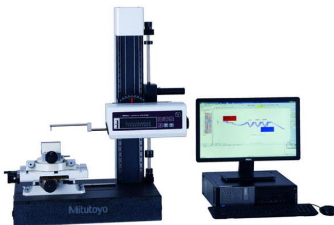
Рис. 1. Внешний вид контурографа Mitutoyo Contracer CV-2100M4
