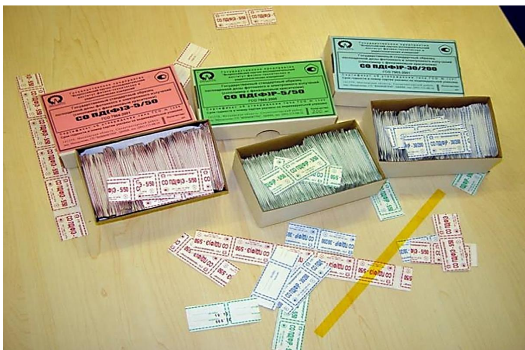
Рис. 1. Внешний вид и способы упаковки серийно выпускаемых стандартных образцов поглощённой дозы (СО ПД) утверждённого типа и обозначения
