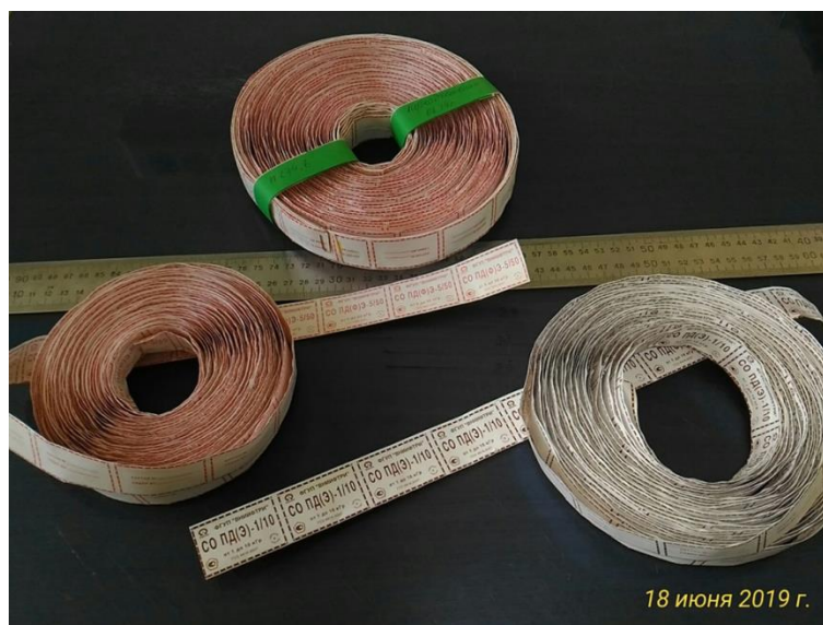
Рис. 2. Внешний вид упакованных протяжённых плёночных дозиметров, изготовленных из заготовок для СО ПД
