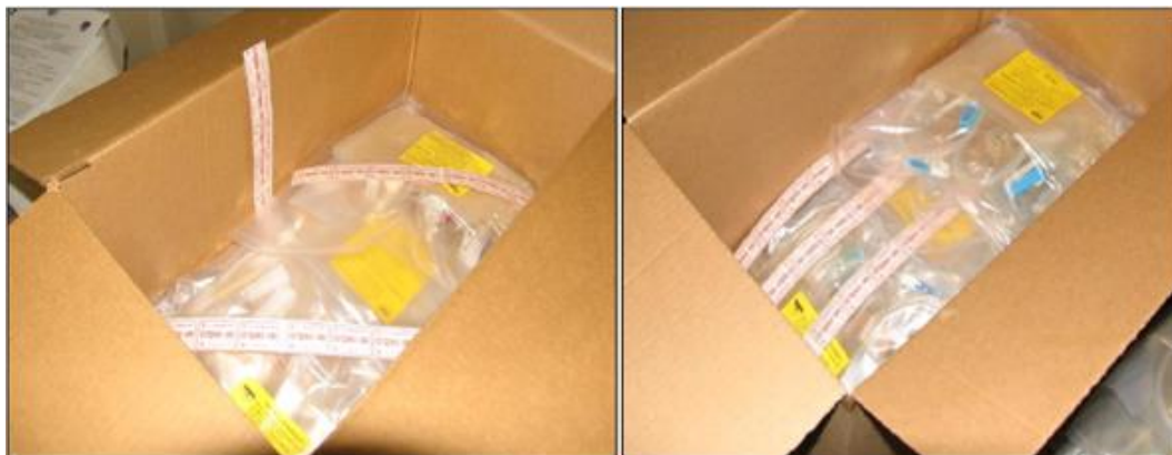
Рис. 6. Примеры размещения протяжённых дозиметров при картировании поглощённой дозы в облучаемой ионизирующим излучением продукции
