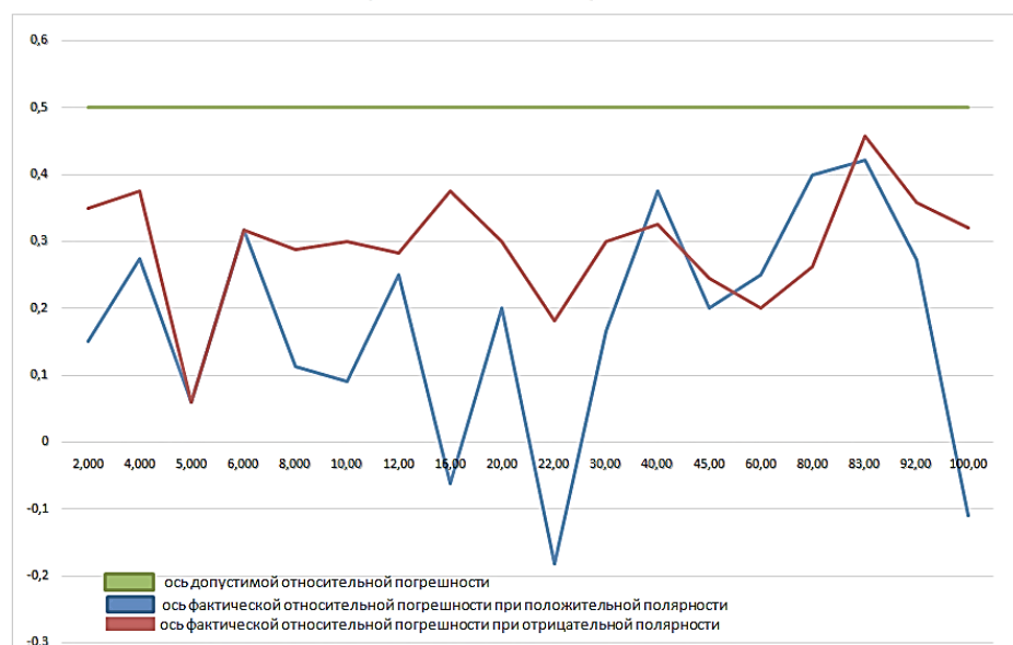
Рис. 6. Отношение относительных погрешностей при разных полярностях к допустимой
