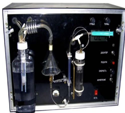
Рис. 2. Комплект для определения сульфидной и меркаптановой серы «Титрион-Сера»
