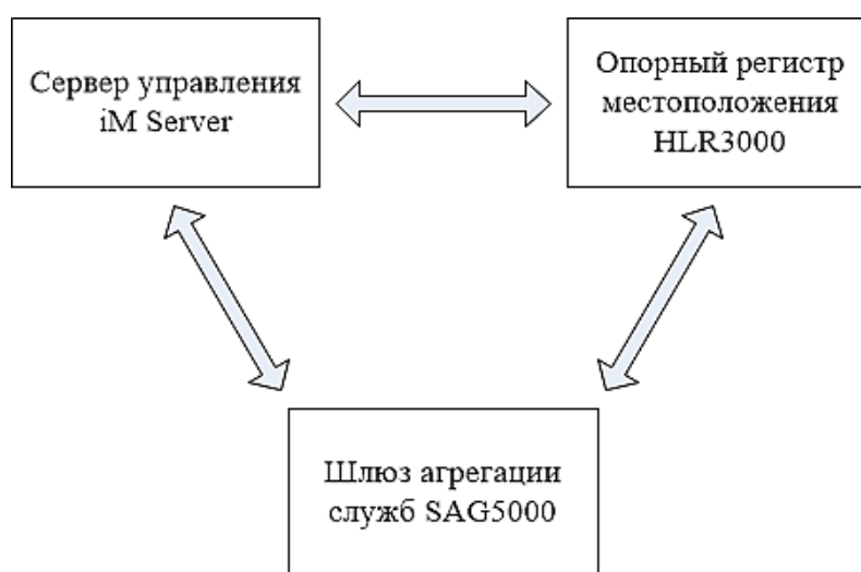
Рис. 7. Архитектура ядра сети МАКВИЛ для АСМОС
