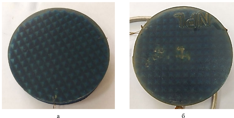
Рис. 4. Фото мишеней из поглощающего материала НАМ-А: целая мишень измерителя (а); повреждённая мишень измерителя (б)
