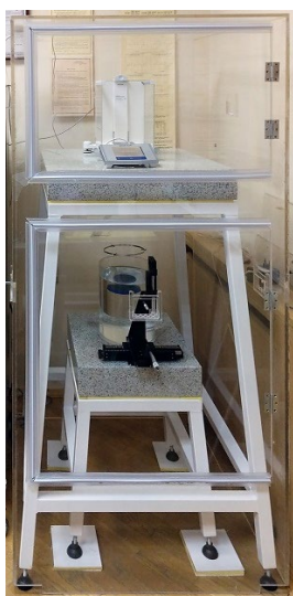
Рис. 3. Эталонный измеритель мощности ультразвука в воде ЭИМУ-3
