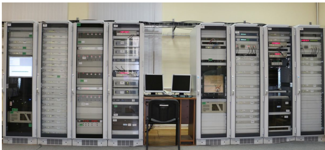
Рис. 8. Комплекс внутренних сличений и комплекс формирования шкал времени
